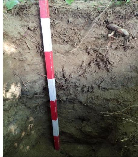
Photo 22 CcFs-4, couche de remblai présent dans le sondage R01, vue vers le nord. (NUM1-7050001)
